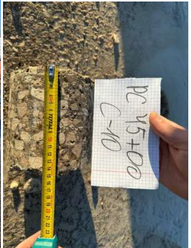
Extragerea/prelevarea carotelor din beton vibrocilindrat cu beton asfaltic și doar din beton vibrocilindrat.
