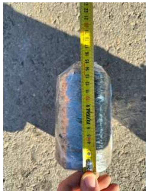
Extragerea/prelevarea carotelor din beton vibrocilindrat cu beton asfaltic și doar din beton vibrocilindrat.
