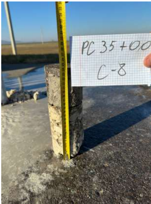
Extragerea/prelevarea carotelor din beton vibrocilindrat cu beton asfaltic și doar din beton vibrocilindrat.
